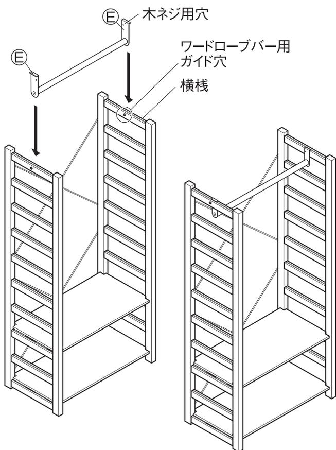
❗ ③ブラケットが横棧にすべて接していることを確認し、傾いていたなら、一度①ボルトをゆるめて調整してください。傾いていると強度が低下し破損の原因となり、ケガをするおそれがあります。
