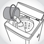
溶け残しをなくすため、約30℃のぬるま湯(約5L)に入れ、よく溶かしてください。溶かさずに入ると、白く残ることがあります。
