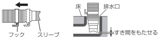
排水ホースは排水時の水の流れや振動などで動く場合があるため、排水口にしっかり差し込み、抜けないことを確認してください。
