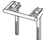
洗濯機の後面に直接取り付けてください。
