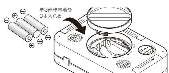
3. バッテリーカバーを「CLOSE」の方向へ回転させて閉めます。
