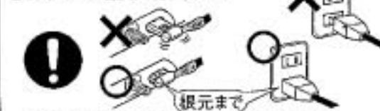
差し込みが浅いと通電不良・火災の原因となります。使用毎によく点検してください。
