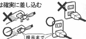
差し込みが浅いと通電不良・火災の原因となります。使用毎によく点検してください。
