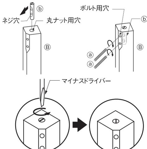
※ネジ穴の位置がずれた場合には、マイナスドライバーで⑨を回し、ボルト用穴にネジ穴を合わせてください。
