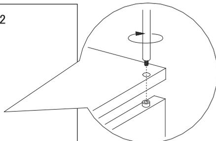
※スチールパイプのボルト部分を下に向け回しながら取り付けます。
