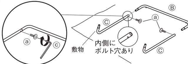
※③ サイドアンダーパイプは内側に穴がくるように配置してください。
