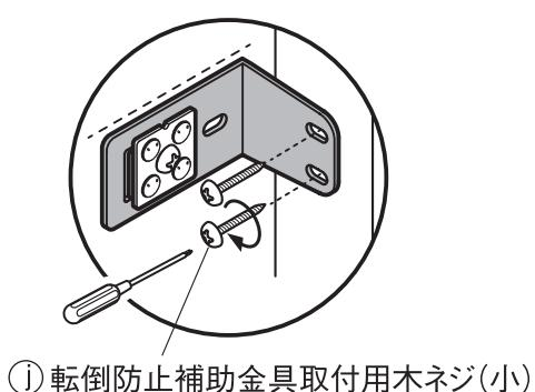
① 転倒防止補助金具取付用木ネジ(小)
