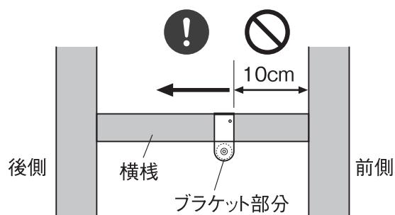
②ブラケットが横桿にすべて接していることを確認し、傾いていたら、一度③ボルトをゆるめて調整してください。
