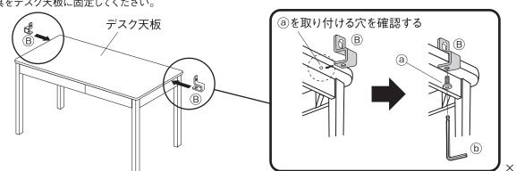
**2** ④本体の溝に®固定金具を合わせて、®固定金具と④本体を@ボルトで固定してください。
