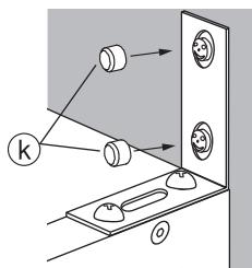
**C : 市販のアンカーボルトや転倒防止器具を用いて固定する
