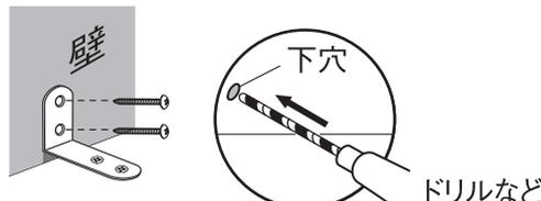
※壁が固くT<sup>ⓐ</sup>を固定しづらい場合は、ドリルを使い、直径2 mmの下穴をあけると固定しやすくなります。
