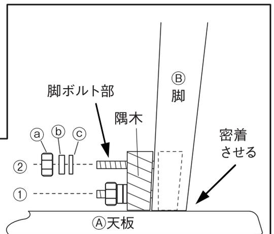
① はじめに天板に近い側の脚ボルト部を固定します。その後、脚と天板の間に隙間がないように密着させて取り付けてください。
