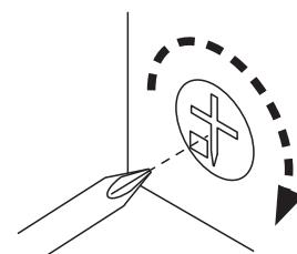
お手持ちのプラスドライバーでカムナットを時計回りにまわし、ジョイントピンにしっかりと締めてください。
