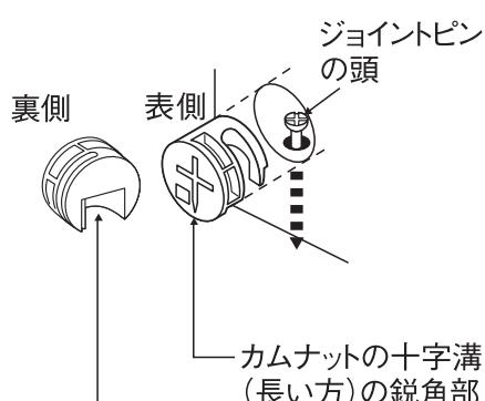
この「開口部」を右図のようにジョイントピンの頭に合わせて押し込んでください。
