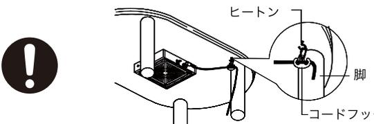
電源コードの固定がないとこたつに入出力する際に、電源コードに足を引っ掛けたりして無理な力が加わり、断線・感電・発火・火災等の原因になります。
