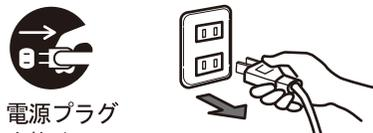
電源プラグを抜く けがややけど、絶縁劣化による感電・漏電・火災の原因になります。
