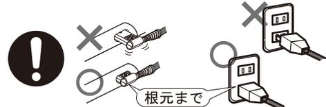
差し込みが浅いと通電不良・火災の原因となります。使用毎によく点検してください。
