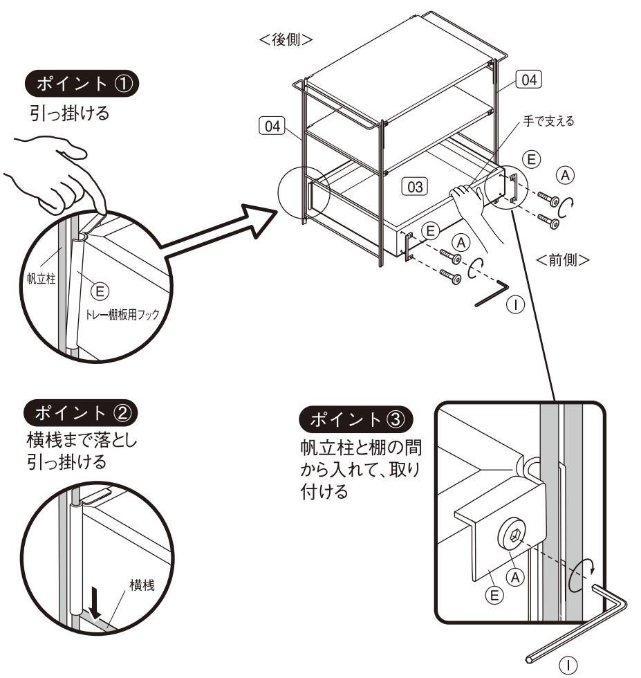
**8** ゆるめに取り付けていた全てのボルトを六角レンチでしっかりと締め付けます。
