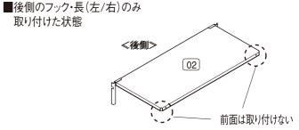
片面(後側)の ⑥ ⑦ フック・長(左/右)を、[04] ワゴン用帆立の帆立柱と横桟に引っ掛け (ポイント①)、帆立柱の横桟まで落とし、しっかりと引っ掛けます。(ポイント②) ※その際、 ⓒ 回 フック・長(左/右)の凹み部分がしっかり横桟に掛かかっているのを、 確認してください。
