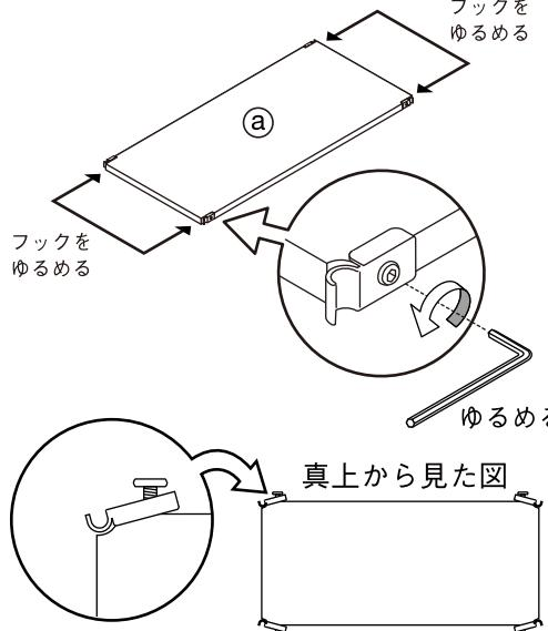
※棚の全てのフックのネジが上図のような状態になるまでゆるめ、フックがハの字になるようにしてください。
