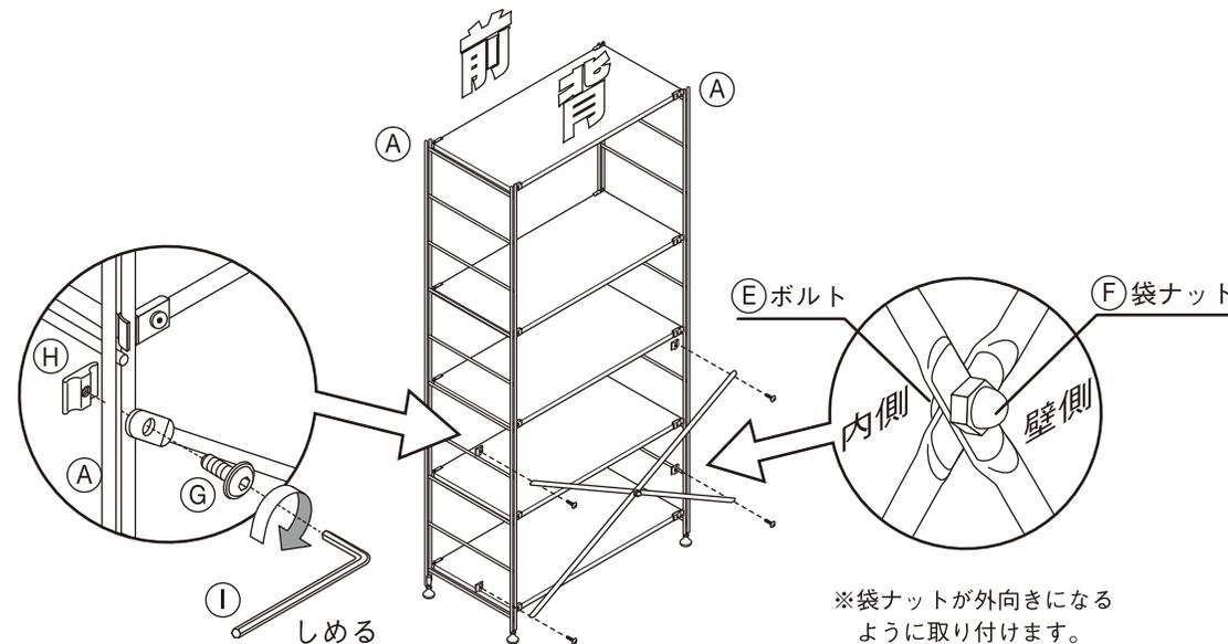
※棚板のフックのネジは、前面、背面と交互に少しずつ締めるようにしてください。一箇所きつく締めてしまうと棚がゆがんで装着され、最後のフックが締めにくくなります。
