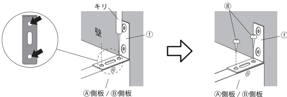
**2** 固定する壁の材質を確認し、①を壁に取り付けます。
