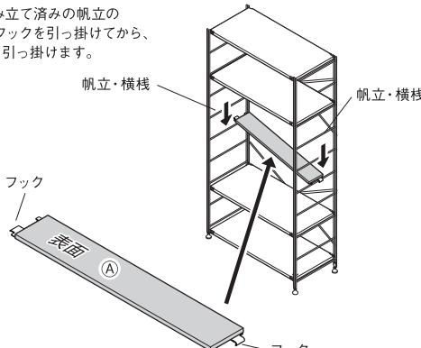
3 ⑤フックを内側に向けて押し、帆立の棟にすき間なく引っ掛けてから、⑦六角レンチで④ボルトをしっかりと締めて固定してください。
