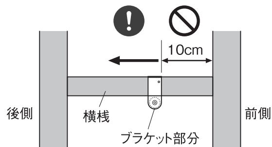
●ブラケットが横桿にすべて接していることを確認し、傾いていたら、一度③ボルトをゆるめて調整してください。
