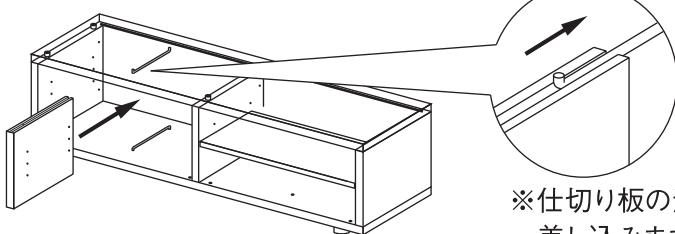
※仕切り板の溝とワイヤーレールの位置を合わせ差し込みます。
