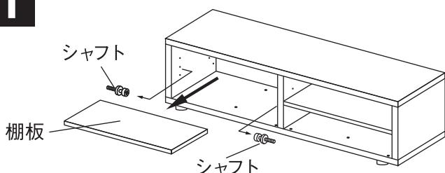
※棚板とシャフトを外す際は、基本セットに付属の「組立・取扱説明書」をご参照の上、組み立ての逆の手順にて取り外してください。
