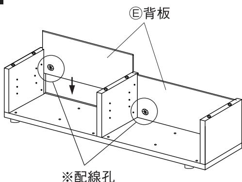
※配線孔の位置は、⑥背板の差し込む向きを変えることで、「左、右」「上、下」から選べます。
