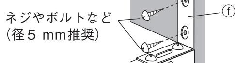
④を壁に押し付けてネジやボルトなどを壁に垂直に締め付けて
