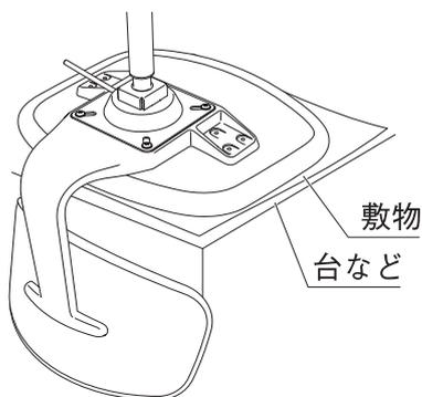
**2** ①アームの先端の穴と座裏の穴を合わせて、②ワッシャー、③スプリングワッシャー、④固定ネジの順に取り付けます。⑤六角レンチを使い、図の矢印の方向(右)に回して、しっかりと締め付けてください。(3カ所)
