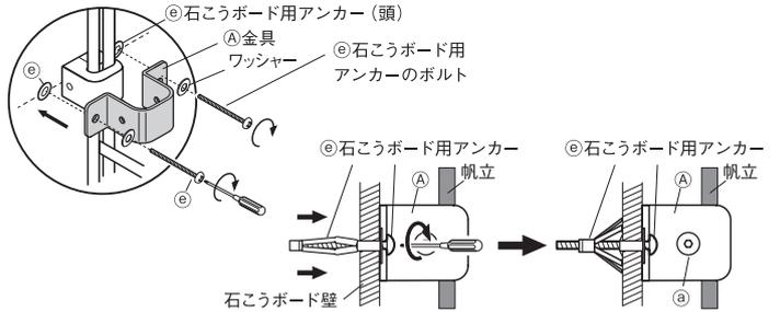
ボルトの頭と金具にすき間がなくなると、抵抗が大きくなりアンカーが変形しはじめます。さらに回し続けてアンカーが十分引き込まれると、強い抵抗を感じて◎金具にガタつきなく固定されます。
