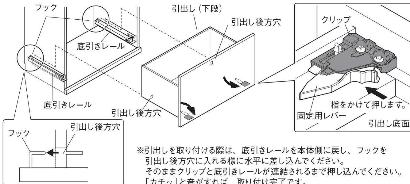
※引出しを取り付ける際は、底引きレールを本体側に戻し、フックを引出し後方穴に入れる様に水平に差し込んでください。そのままクリップと底引きレールが連結されるまで押し込んでください。「カチッ」と音がすれば、取り付け完了です。
