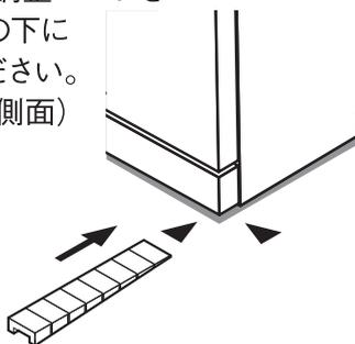
※隙間の大きさに合わせてパーツを差し込む位置を調整してください。
