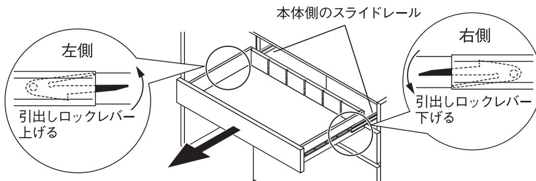
※引出しを取り付ける場合は、本体側のスライドレールを本体側に戻し、レール位置を合わせて水平に差し込みます。
