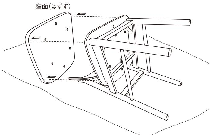
3 新しいⒶ 交換座面を同じ位置に合わせ、Ⓑ ワッシャーに通したⒶ ボルトを6ヶ所、付属の④六角レンチで時計回りに回して軽く締めます。
