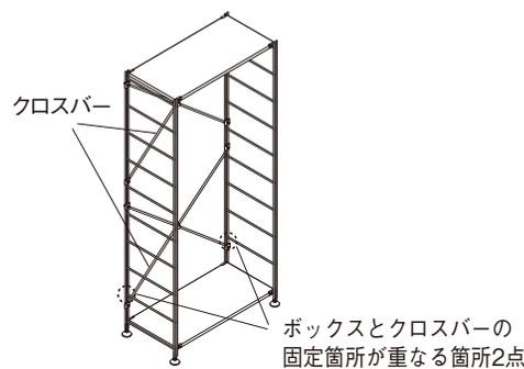
**注意** ボックスとクロスバーの固定箇所が重なる位置には、ボックスと同梱されているスペーサーを取り付け、ボルトとボックスが触れないようにしてください。
