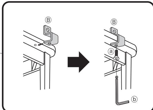
2 ①本体の溝に②固定金具を合わせて、Ⓐボルトで②固定金具と①本体を固定してください。
