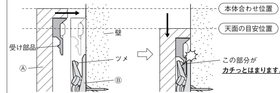
取り付け後、壁との間に隙間がないか、カタカタ動かないか確認してください。隙間がある、カタカタ動く場合は取り付け直してください。
