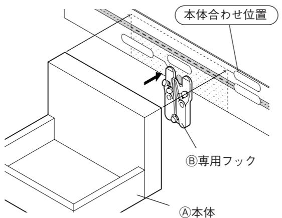
② そのまま④の天面（下図斜線部分）を押しながら、天面の目安位置まで下げ、カチっとはまるのを確認してください。天面の目安位置に合わせないと、フックに無理な力が加わり、破損する場合があります。（<ポイント>参照）
