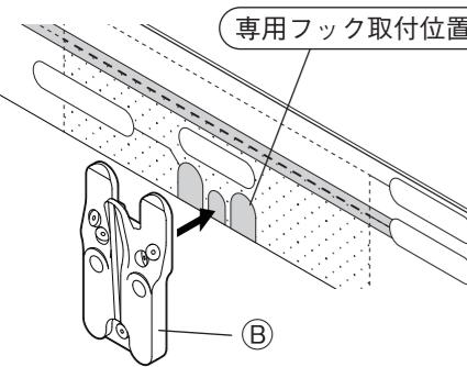
② ④専用フックのピン穴に【図1,2,3】の順番で⑤専用固定ピン（5本）を刺してください。硬く感じる場合は、脱着工具をご使用ください。
