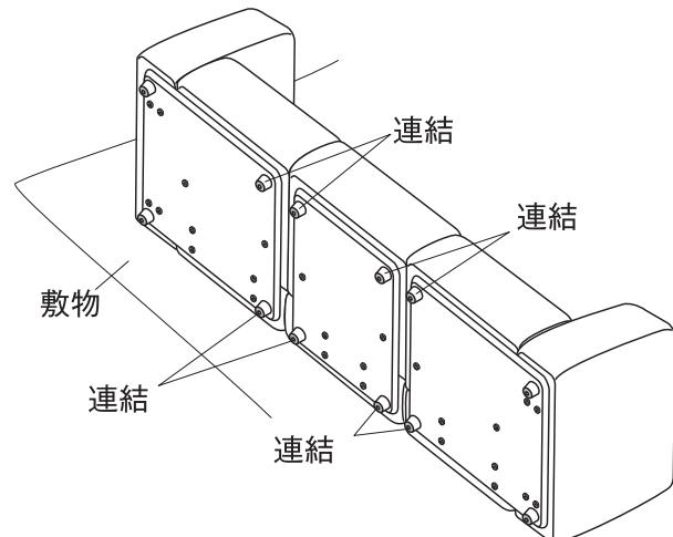
**2** ①連結する脚を固定しているボルトを④六角レンチを用いてゆるめて取りはずしてください。
