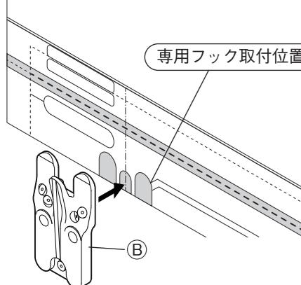
② ③のピン穴に【図1,2,3】の順番で④×5を刺し、②を壁にしっかりと固定してください。硬く感じる場合は、⑤脱着工具をご使用ください。
