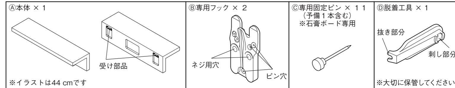
注意 ①専用固定ピンは石膏ボード専用です。吸音ボードなど、石膏ボード以外の壁には使用しないでください。
