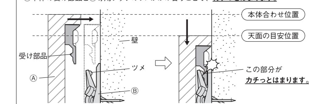
取り付け後、壁との間に隙間がないか、カタカタ動かないか確認してください。隙間がある、カタカタ動く場合は取り付け直してください。取り付け後、左右に動くのは異常ではありません。
