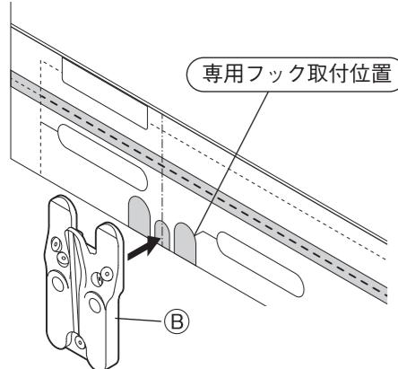
② ②のピン穴に【図1,2,3】の順番で③×5を刺し、②を壁にしっかりと固定してください。硬く感じる場合は、④脱着工具をご使用ください。
