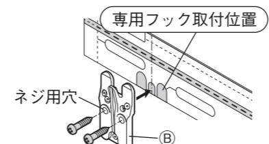
3 ① ①を本体合せ位置と左側面の合せ位置に合わせて壁に押します。
