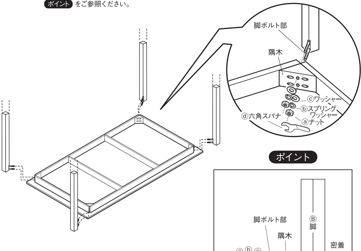
①はじめに天板に近い側の脚ボルト部を固定します。その後、脚と天板の間に隙間がないように密着させて取り付けてください。完成後にガタツキの原因になります。
