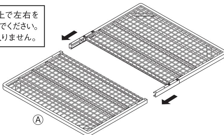
② 1-③同様(A)スチールフレームと(B)C型連結金具を下図のように(a)ボルト、(b)キャップナット、(c)ワッシャー、(d)スプリングワッシャーを使用し取り付けます。
