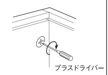
お手持ちのプラスドライバーでカム ナットを時計回りにまわし、ジョイント ピンにしっかりかみ合わせてください。 仕様上、カムナット穴はきつめに設定 されております。カムナットがカムナット 穴に入りにくい場合は、ドライバーなど で強めに押し込んでください。
