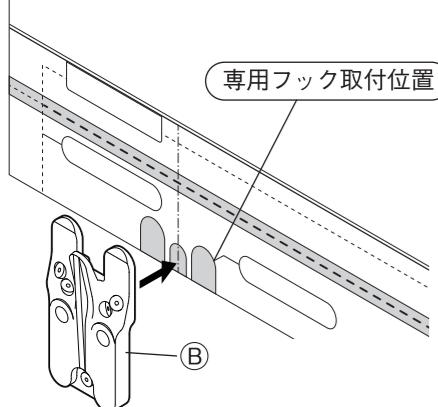
② ③専用フックのピン穴に【図1,2,3】の順番で④専用固定ピン（5本）を刺してください。
