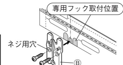
**3** ① ④を本体合せ位置と左側面の合せ位置に合わせて壁に押します。
