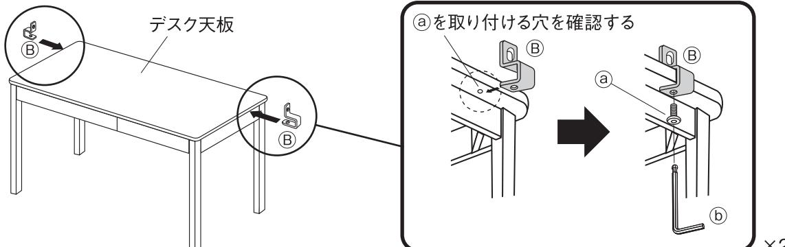
2 ③本体の溝に④固定金具を合わせて、④固定金具と③本体を⑤ボルトで固定してください。
