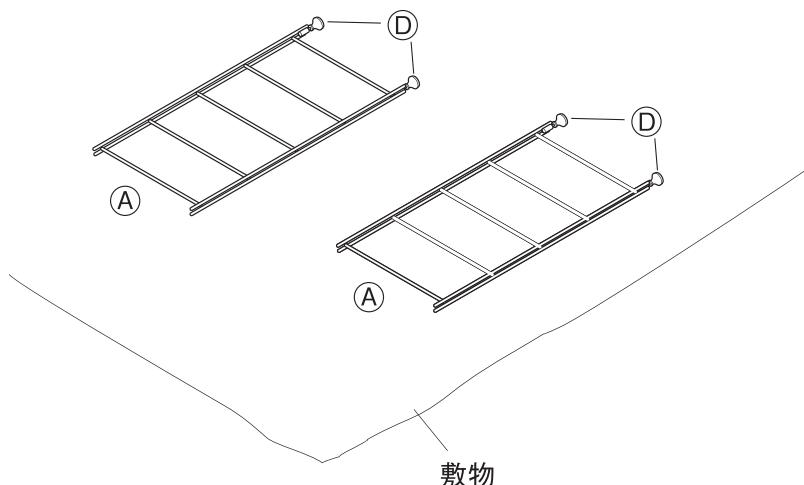
**2** ②棚板の四隅に固定されているフック用ボルトを⑤でフックが自由に動く状態までゆるめてください。
