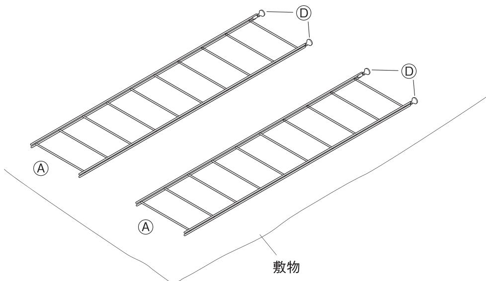
**2** ②棚板の四隅に固定されているフック用ボルトを④でフックが自由に動く状態までゆるめてください。
