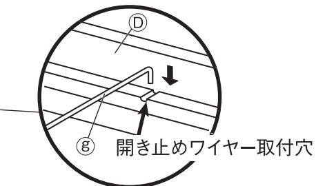
① ⑥開き止めワイヤーを⑦サイドレールの受け桿にある開き止めワイヤー取付穴に差し込みます。
