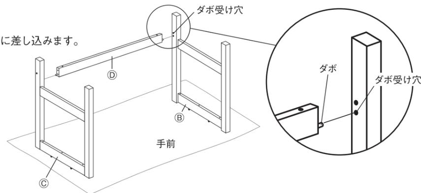
② ⑩幕板のダボと⑧左脚、⑨右脚のダボ受け穴を接合した後、⑪を⑩に差し込み、お手持ちのマイナスドライバーを⑫の溝に合わせ、⑫のボルト穴が側面に向くように調整してください。
