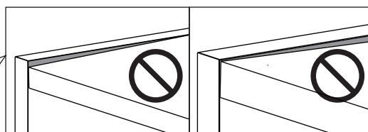
⑤側板（短）を配置した際、8と高さが合うように固定してください。
