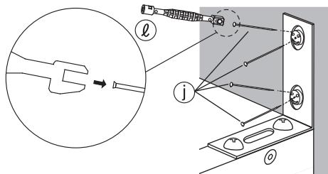
⑥ピン押し具を持ち替えて、①細ピンを最後まで差し込んでください。
