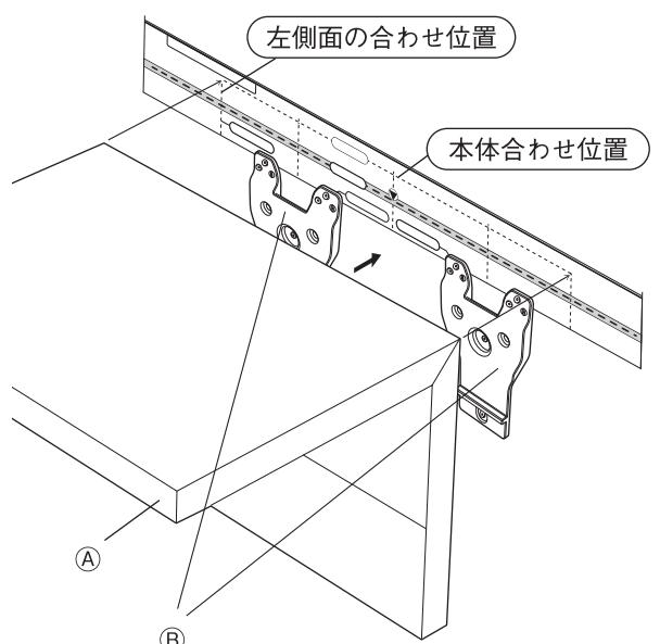
② そのまま④本体の天面(下図斜線部分)を押しながら、天面の目安位置まで下げる、カチッとはまるのを確認してください。
