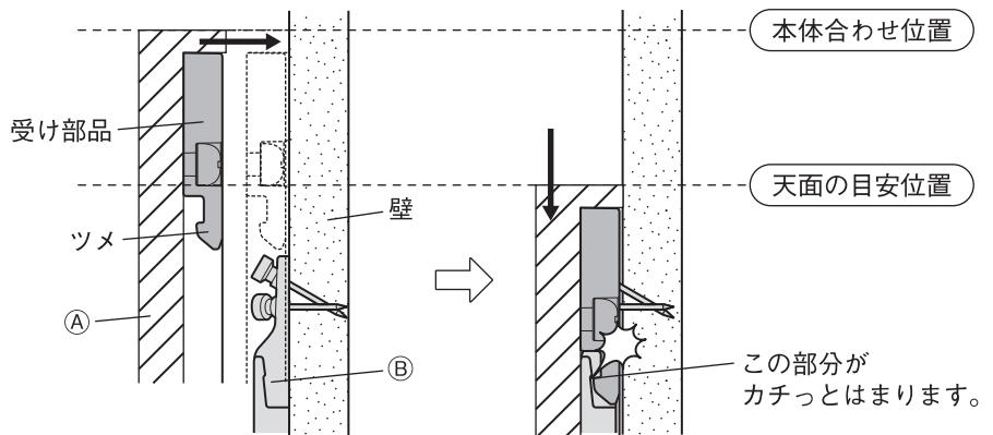
取り付け後、壁との間に隙間がないか、カタカタ動かないか確認してください。隙間がある、カタカタ動く場合は取り付け直してください。
