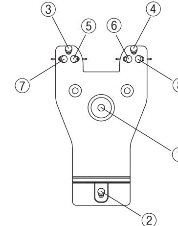
3 ① ④本体を本体合せ位置と左側面の合せ位置に合わせて壁に押し当てます。
