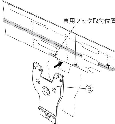
② ②専用フックのピン穴に下図の順番で③石膏ボード専用固定ピンを刺し、④を壁にしっかりと固定してください。
