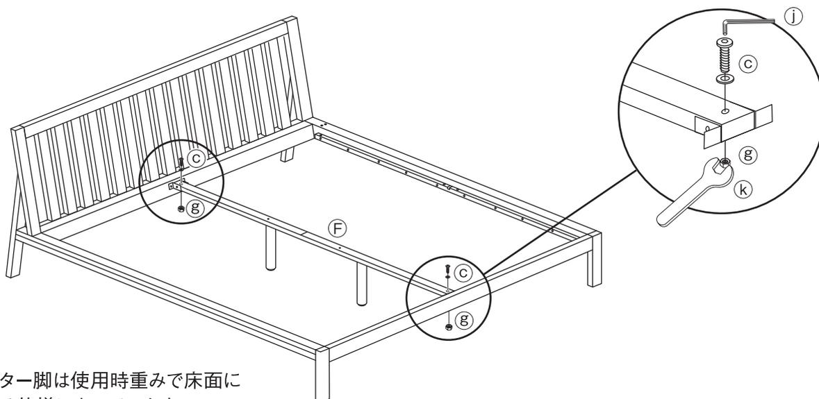
(E) センター脚は使用時重みで床面に接地する仕様になっています。
