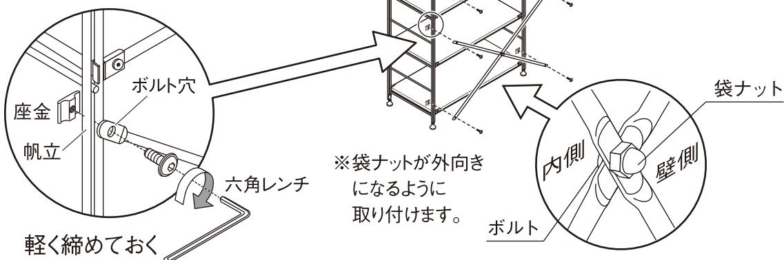
**7** 最後に、手順 **2**～**4** で軽く締めた追加棚のフック用ボルトと、手順 **5**～**6** で軽く締めたクロスバー中心用のボルトとクロスバーのボルトを、六角レンチできつくなるまで締めてしっかりと固定します。
