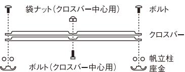
2 棚板を全て取り付けてからシェルフの背面側から(④)座金と(⑤)ボルトで図のように帆立、(Ⓐ)クロスバーを間にはさんで、(e)六角レンチを使いクロスバーを固定してください。クロスバー中心の(⑥)袋ナットと(⑦)ボルト(クロスバー中心用)を(⑧)六角レンチを使い、しっかりと締め付けてください。
